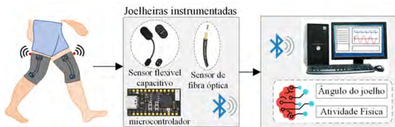
Figura 1. Sistema de sensores vestíveis proposto para o monitoramento de atividade física
