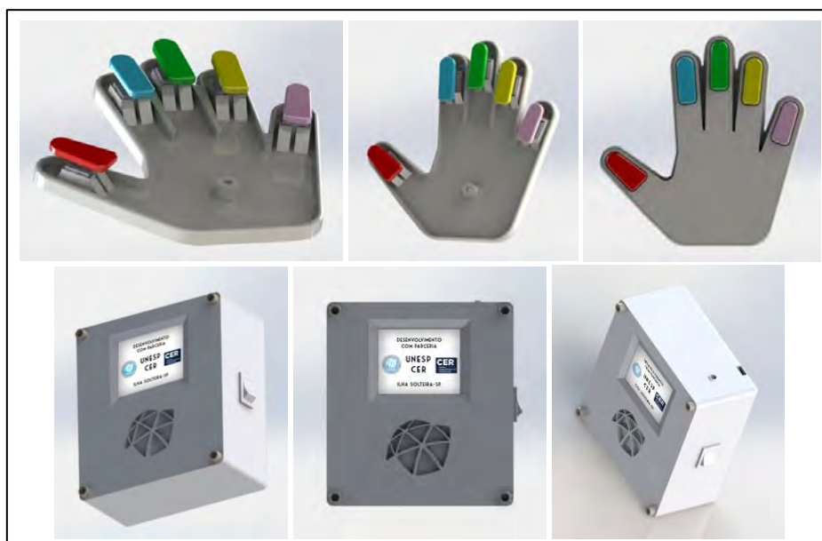
Figura 2. Mão acionadora dos botões (a, b, c); central eletrônica (d, e, f).
