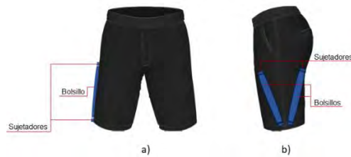
Figura 2. Diseño pantalón del wearable textil. a) Vista frontal. b) Vista lateral. Adaptada de [11].
