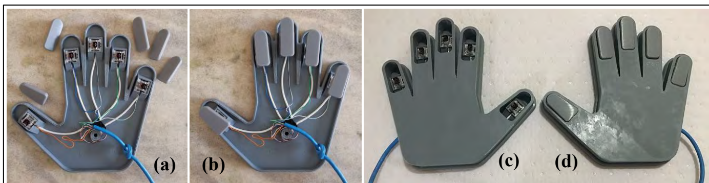
Figura 3. Switches soldados, com botões desencaixados (a, c) e encaixados (b, d).
