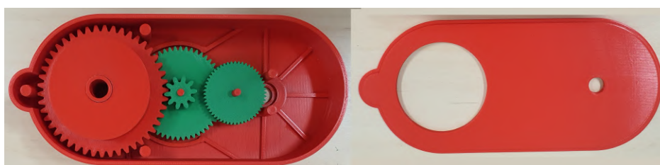
Figure 3. Caixa de redução impressa.
