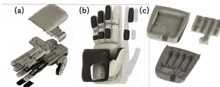
Figura 1. (a) Prótese com vista explodida no Fusion 360; (b) Peças emborrachadas modeladas; (c) Diferença entre a prótese original e o case desenvolvido para os motores.
