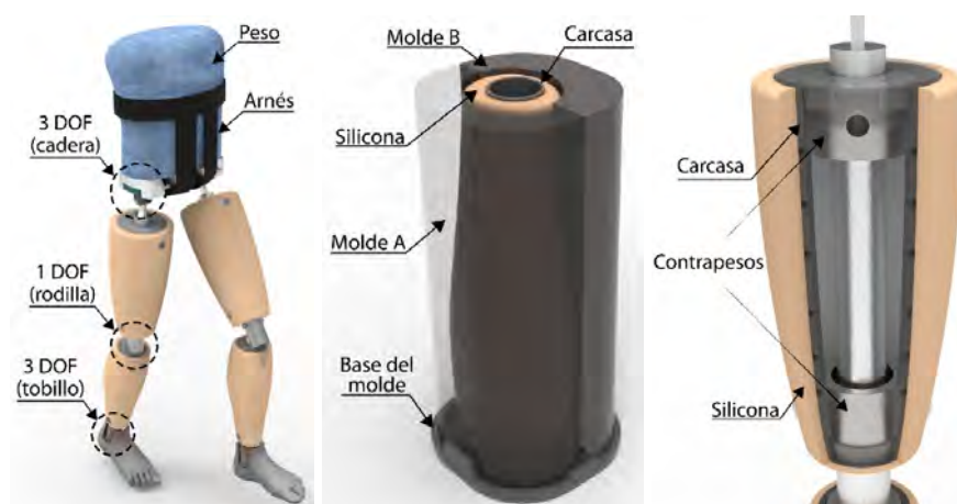
Figura 2. (a) Diseño final del maniquí. (b) Molde de la tibia. (c) Vista en sección del interior del muslo.
