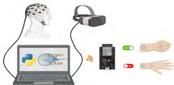
(c) Ilustração do sistema de conexão entre o laptop, os óculos de realidade virtual e o EEG, incluindo a transmissão de sinais para a ativação do EEF.
